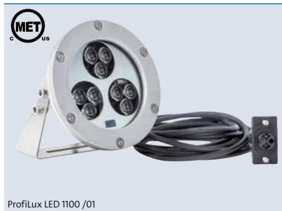
Der Scheinwerfer wird mit einem Halterbügel und Feinjustierung geliefert. Der LED Scheinwerfer verfügt über ein 4 m langes Anschlusskabel mit einer wasserdichten 24 V / DC Steckverbindung.
