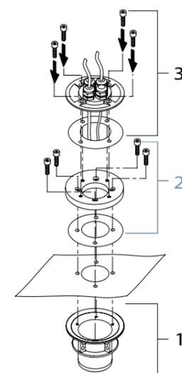
**1** Das Betonteil ist die Basis für jede Konfiguration. Erhältlich für Rohre DN 70 bzw. DN 100.
