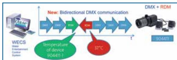
DMX/RDM Der DMX-Bus ist jetzt bidirektional. Dies ist durch die Protokollerweiterung RDM (Remote Device Management) möglich geworden. Die Anschlusstechnik bleibt unverändert.
