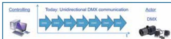
DMX ist ein Kommunikationsprotokoll (Digitaler Multiplex). Dieses Produkt nutzt die unidirektionale DMX Kommunikation.
