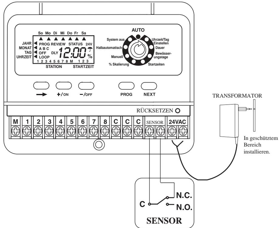
Zum Anschluss eines Regensensors nehmen Sie den Jumper von der Sensoranschlussleiste ab und verbinden eine Leitung des <<Irritrol Rain Sensor>> mit dem gemeinsamen C-Anschluss, den anderen mit dem Öffnerrelaisanschluss (N.C.). Die Bewässerung wird ausgesetzt, sobald die Kontakte des <<Rain Sensor>> aus ihrer geschlossenen in die geöffnete Stellung wechseln. Die Bewässerung setzt wieder ein, wenn der Regenschalter getrocknet ist und die Kontakte in die geschlossene Position zurückgekehrt sind.
